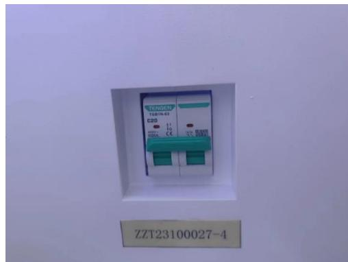
Schalten Sie die Geräte-Sicherung ein und schalten Sie das Gerät dann normal ein.
